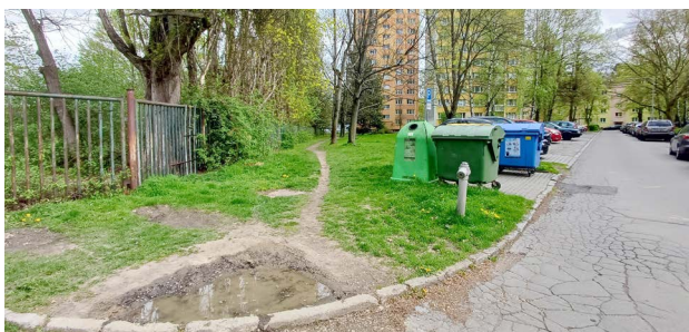
Chybějící chodník na ulici Svazácká a chybějící pěší propojení (vyšlapaná pěšina podél plotu), 2024. ZDROJ: MAPPA
